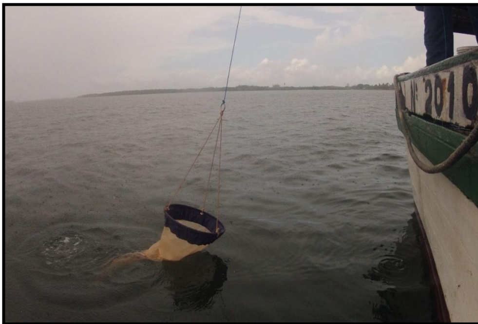
Figura 71. Rede sendo utilizada na amostragem do fitoplâncton (Fonte: Patrícia Pinheiro).
